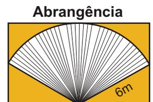
A abrangência é reduzida quando o movimento é realizado na direção do sensor.
