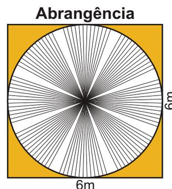
A abrangência é reduzida quando o movimento é realizado na direção do sensor.
